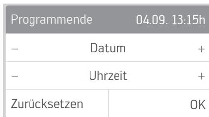
Geben Sie durch Drücken der Leuchtbalken Datum und Uhrzeit für das Programmende ein (15 min-Schritte).
