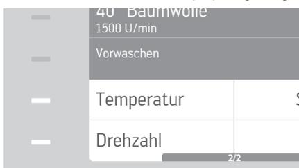
Durch Drücken des Leuchtbalkens bei **Drehzahl** lässt sich die Drehzahl in Schritten von 100 U/min verringern. Bei 0 U/min erfolgt kein Schleudern und die Wäsche kann nass entnommen werden.
